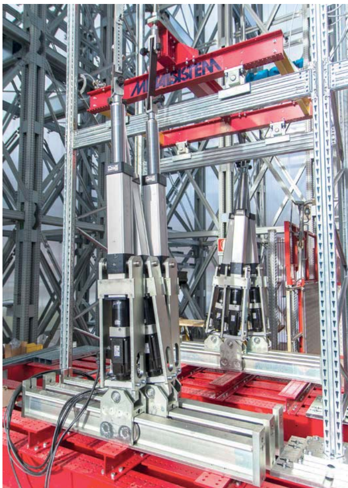
Fig. 10 – Dettaglio della macchina di prova in allestimento all'interno della torre di contrasto
